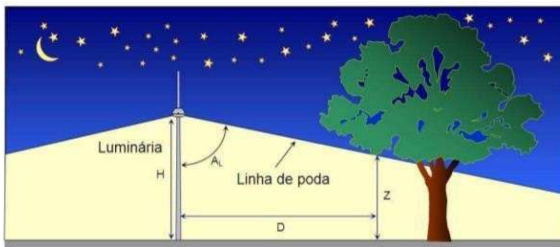
Projeção da desobstrução longitudinal - fonte: ND-3.4 Cemig
